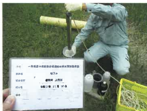
地下水採取（A棟周辺）
