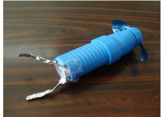
底のフタを外し、セロハンテープでアルミ箔を貼り付けるだけです。
